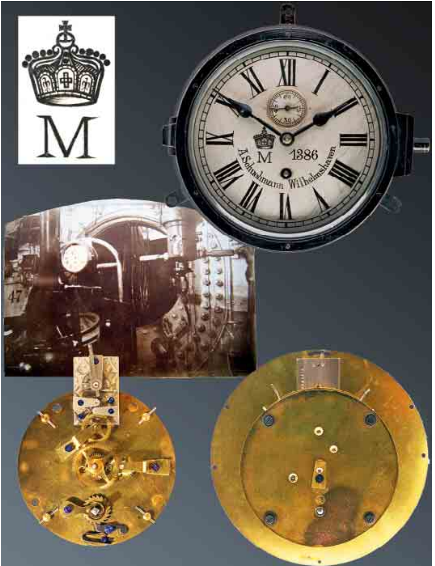
Schiffswanduhren der Kaiserlichen Marine: - A. Schuchmann Wilhelmshaven, Schiffswanduhr M 1386.Nr. 2071357, Gehäuse, Zifferblatt, Werk und Hemmung nummerngleich, massives Messingzifferblatt Messingwerk, mit Schraubenunruh, Breguetspirale und Malteserkreuz, 8-Tage-Werk von Gustav Becker aus Freyberg in Schlesien. - Foto: Wand in einem U-Boot des Ersten Weltkrieges.
