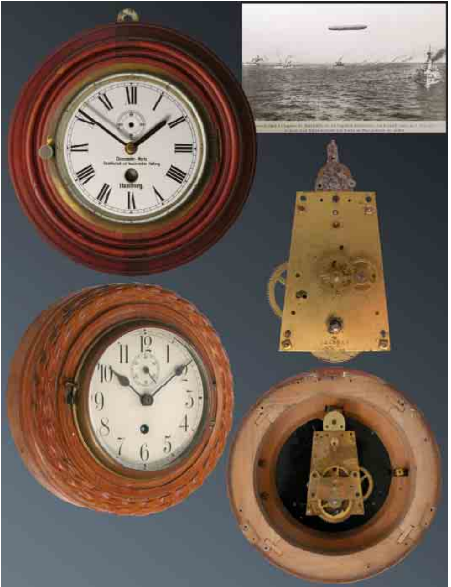
Schiffswanduhren der Kaiserlichen Marine: - Chronometerwerke Hamburg - Franz Happe Kiel, Schiffswanduhr, 8-Tage-Werkwerk von Gustav Becker aus Freyberg in Schlesien, Nr. 2140657, Email-Zifferblatt, Stiftanker- Messingwerk, schweres Holzgehäuse. Foto: die Kaiserliche Flotte mit Masrine-Zeppelin.
