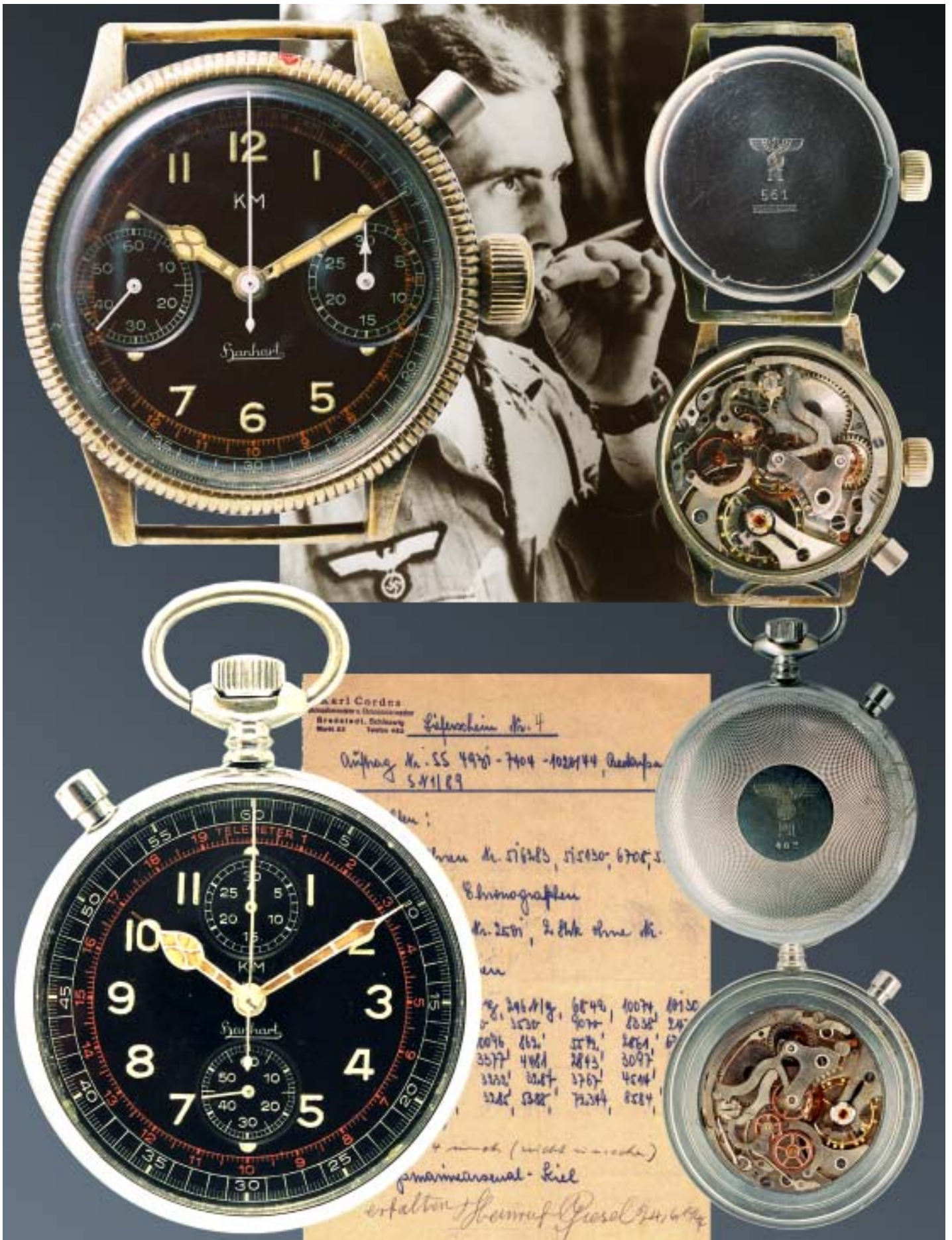
Hanhart Chronographen der Kriegsmarine: - Hanhart Taschen-Chronograph Reg.Nr. M 462 und Reichsadler, Werk Cal. 40. - Ein-Drücker-Version mit Telemeter-Skala für U-Boot-Kapitäne, aber auch bei den Marine-Fliegern gehörten diese Armbandchronographen zur sinnvollen Ausrüstung, Edelstahlboden, vernickeltes Gehäuse, Werk Nr. 113907, Marine-Nr. 561, Zifferblatt signiert 'KM', Leuchtindikation, 30-Minutenzähler, Cal. 40, 17 Steine, Schraubenunruh, Breguet-Spirale, Incabloc-Stoßsicherung, d = 40 mm. Hanhart wrist chronographs of the Kriegsmarine: - Hanhart pocket chronograph eagle M 462, cal. 40. - one pusher version with telemeter scaling for U-boat captains, the Navy pilots did use these chronographs as well, movement no. 113907, Navy registration no. 561, nickel case and steel back, dial printing with 'KM', luminous Radium numerals, 30 min counter, cal. 40, 17 jewels, screw balance, Breguet spring, Incabloc shock proof, d = 40 mm.
