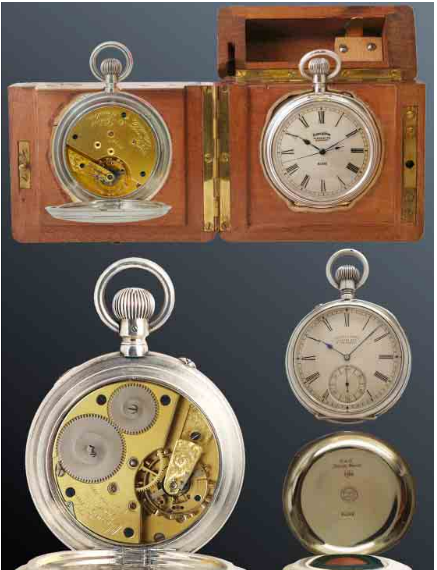
A. Lange & Söhne, No. 81797, ca. 1918 Halb-Sekunden-Deck-Chronometer, geliefert an das k.u.k. Hydrografische Amt in Pola am 17.05.1918 in der originalen „Pola“-Holztransportbox, 39 Exemplare gebaut. Silber-Gehäuse, Zentralsekunde, Wippenchronometerhemmung. unten: A. Lange & Söhne Beobachtungs-Chronometer, (Nummern im Foto entfernt), Silber, Werk: 3/4 Platine, Chronometerrad und Glashütter Kurz-Wippe, geliefert 19.11.1904 an das k.u.k. Hydrographische Amt Pola.
