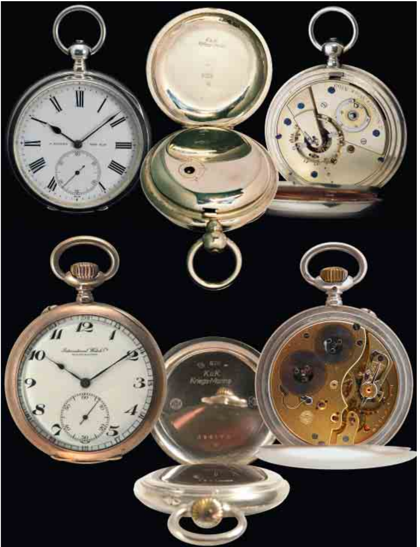
Beobachtungsuhren Österreichisch-Ungarischen Kriegsmarine: -oben: Josef Nicolaus Wien, Chronometeruhr No. 55, um 1890, Gravur: K.u.K. Kriegsmarine, Topfform-Unruh, Silber, 52 mm Schlüsselaufzug-Werk, Feder-Hemmung. -unten: IWC Schaffhausen/Schweiz, Geh- Nr. 399170, Werk Nr. 379440, gel. 1907 an Leopold Löwith Wien, Cal. 52 mit Feinreglage, vergoldetes 2/3 Platinenwerk, Silber-Gehäuse, Email-Zifferblatt, Markierung innen 'K.u.K. Kriegsmarine'. (Privatbesitz, Fotos K. Knirim Juli. 2003) Navigation watches of the Austria-Hungarian Navy in WW1: - Josef Nicolaus Wien, chronometer watch no. 55, ca. 1890, marking: k.u.k. Kriegsmarine, silver, 52 mm, key winding, spring detent. - below: IWC case no. 399170, movement no. 379440, cal. 52 of 1907, marking inside: 'K.u.K. Kriegsmarine'
