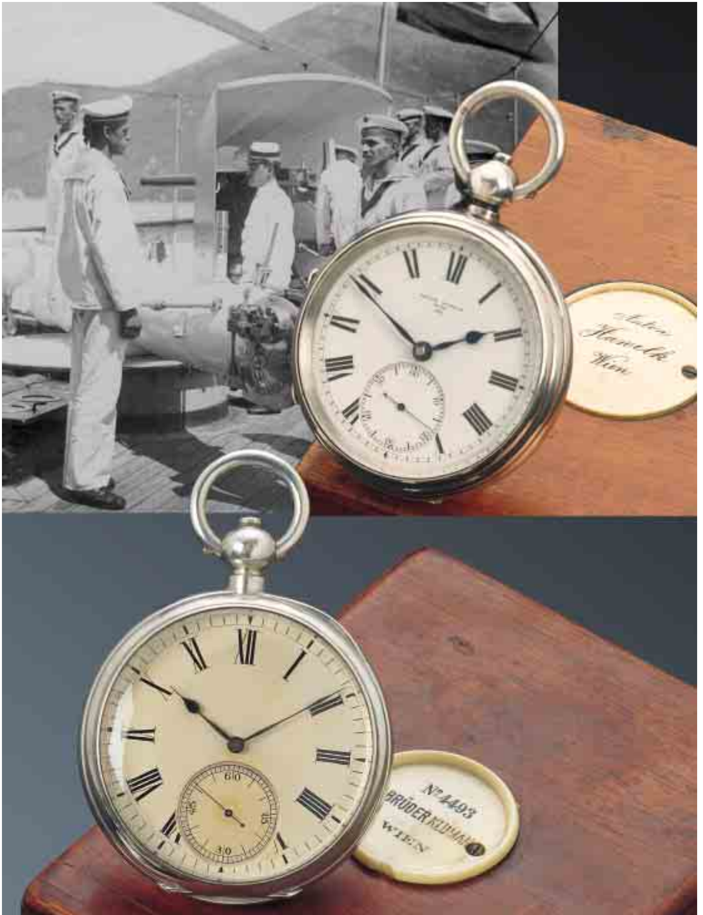
- oben: Anton Hawelk Wien Nr. 560 für die Kaiserliche und Königliche Kriegsmarine von Österreich-Ungarn, Chronometeruhr, Kette-Schnecke-Werk mit Feder-Hemmung. - unten: Brüder Klumak Wien, No. 4493, ca. 1870, Chronometeruhr für die k.u.k. Kriegsmarine, 'vom Amte verkauft'. Silber, 22''' \frac{3}{4} -Platinenwerk mit Schlüsselaufzug. - Foto: Torpedofahrzeug Trabant der k.u.k. Kriegsmarine, Torpedo-Exerzieren am Decklanzierapparat, im Hintergrund die Dalmatinische Küste. (Österr. Kriegsarchiv). - top: Anton Hawelk Vienna no. 560 for the 'Kaiserliche und Königliche Kriegsmarine von Österreich-Ungarn', chronometer watch, fusee chain movement with spring detent. - bottom: Brothers Klumak Vienna, no. 4493, ca. 1870, chronometer watch for the k.u.k. Kriegsmarine, 'vom Amte verkauft', silver case, 22''' \frac{3}{4} -plate movement with key. - Photo: Torpedo boat Trabant of the Austrian-Hungarian Navy, training at the torpedo unit, in the background the Dalmatian coastline.
