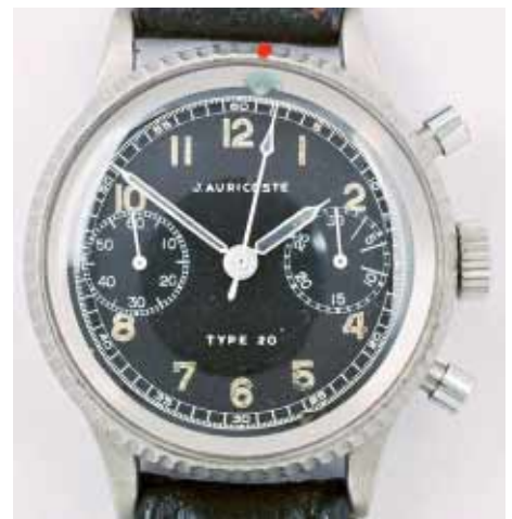
Auricoste Fliegerchronograph der französischen Luftwaffe: Verchromtes Gehäuse, Boden verschraubt, 30 min-Zähler, Lunette, 'Flyback', Cal. Lemania 2040, Nr. 802805 Beschaffungskennzeichen: 'Type 20' und Revisionsdaten auf dem Boden.
