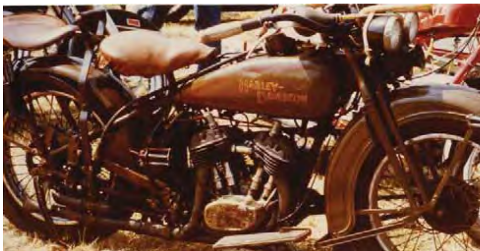
Typ 29 R oder D mit 45" = 750 ccm seitengesteuertem Zweizylindermotor
